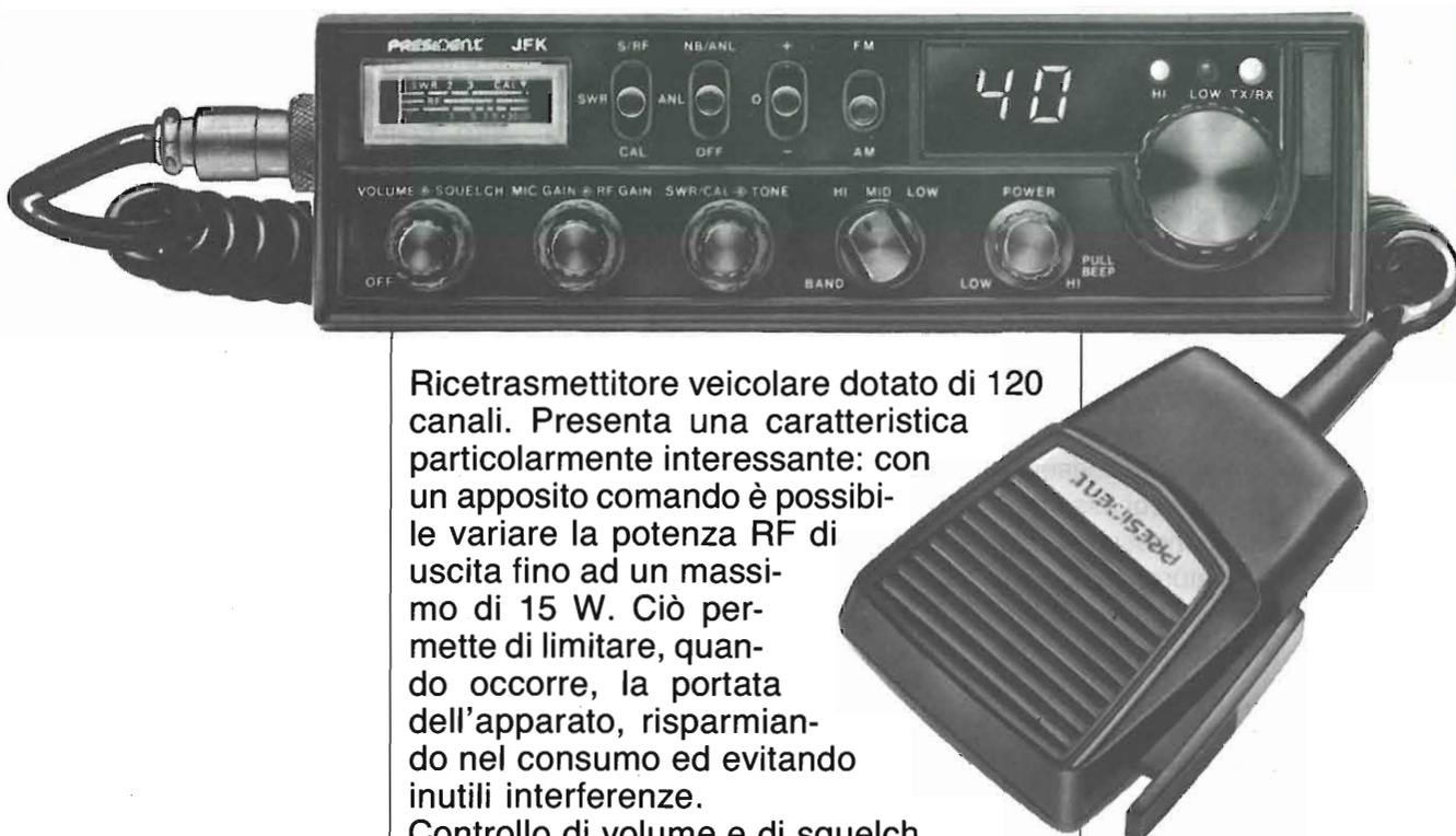
Ricetrasmittitore veicolare dotato di 120 canali. Presenta una caratteristica particolarmente interessante: con un apposito comando è possibile variare la potenza RF di uscita fino ad un massimo di 15 W. Ciò permette di limitare, quando occorre, la portata dell'apparato, risparmiando nel consumo ed evitando inutili interferenze.
